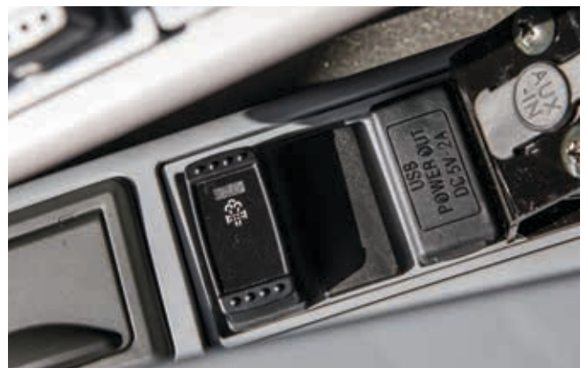
La presa di alimentazione USB consente di ricaricare dispositivi portatili come i telefoni cellulari.
