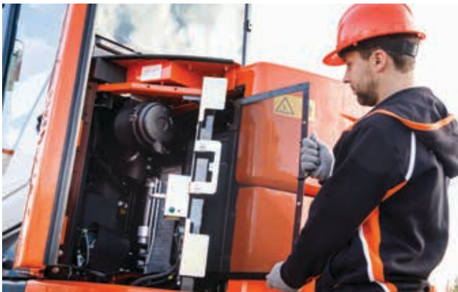
Il radiatore è dotato di una rete antipolvere facile da pulire.
